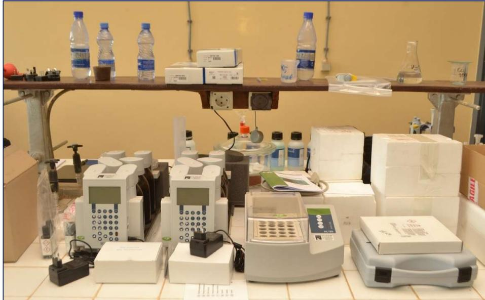
**Figure 1.14.** Système de mesure de la DBO
