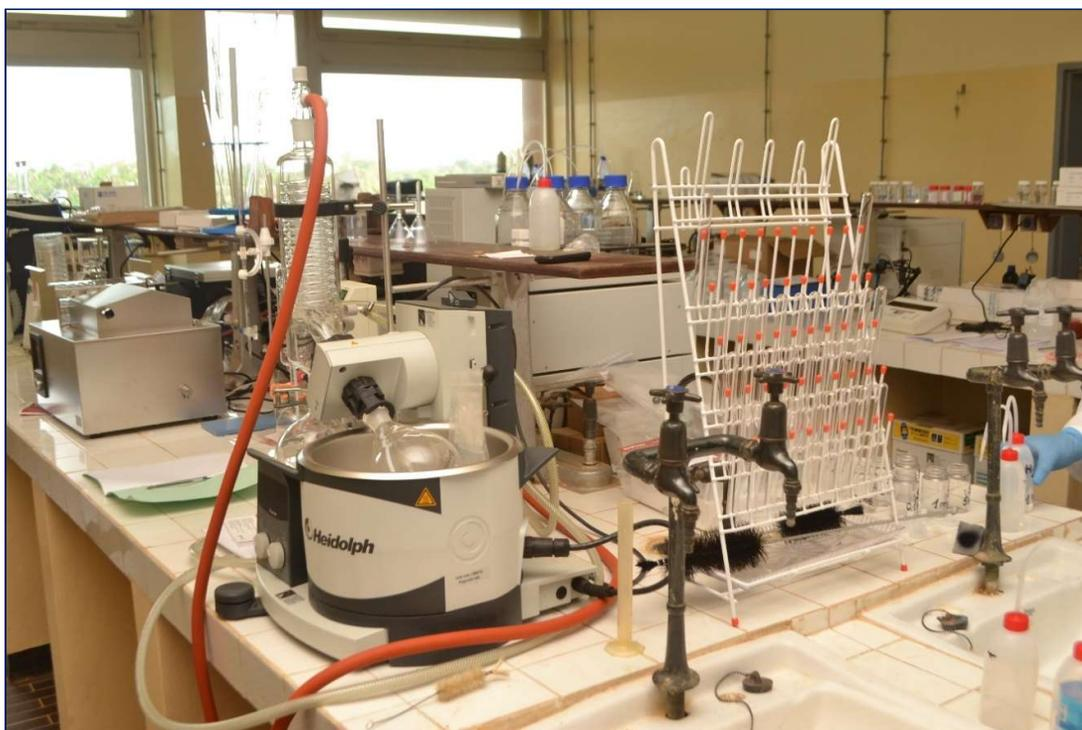
**Figure 1.11.** Evaporateur rotatif du laboratoire d'Environnement
