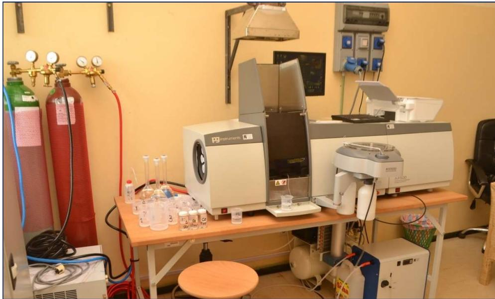
**Figure 1.8.** Spectromètre d'Absorption Atomique avec configuration flamme-four graphite (SAA)
