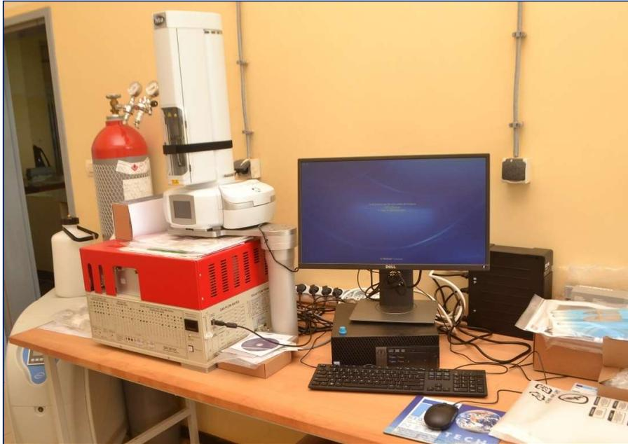
**Figure 1.7.** Système de Chromatographie en phase Gazeuse (GC)
