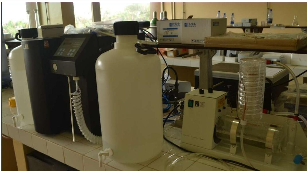
**Figure 1.10.** Unité de production d'eau distillée et d'eau ultra-pure
